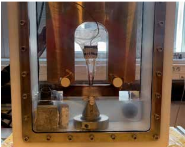
Medición de las propiedades de fatiga en ambiente corrosivo
